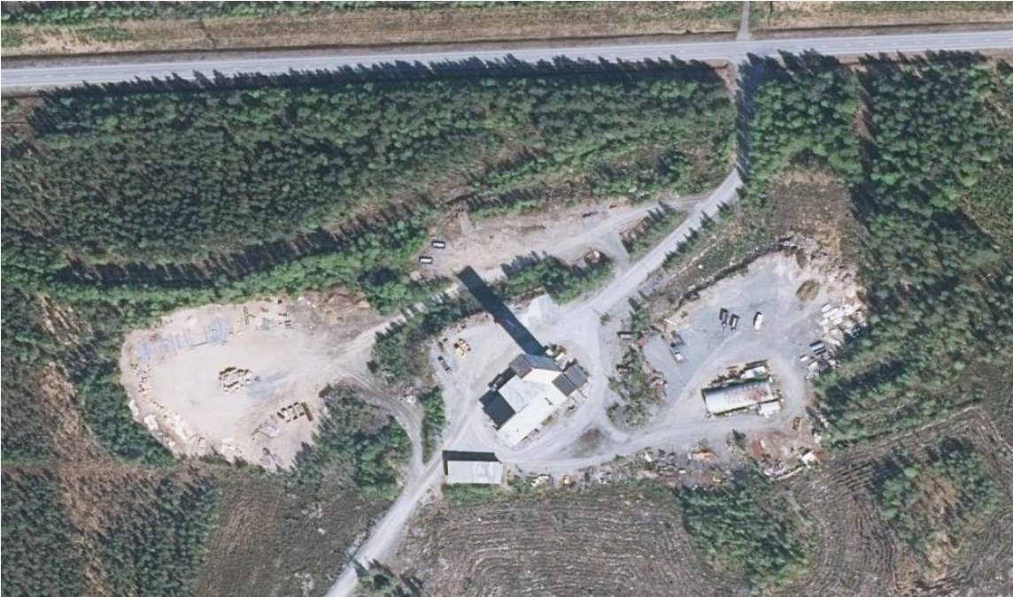
Kuva 45. Vuorokkaan kaivoksen alue Kokkolantien eteläpuolella, 2024. Kaivos ulottuu myös Kokkolantien pohjoispuolisille alueille. Alueen keskellä on korkea kaivostorni, jota ympäröi matala teollisuus/toimisto/varastorakennus. Sen vieressä on konekatos. Sivummalla on asfaltoidun piha-alueen ympäröimä kaarihalli. Rakennusten ympärillä on mm. varastointiin käytettyjä avoimia piha-alueita. (Ortokuva Maanmittauslaitos / Paikkatietoikkuna.)
